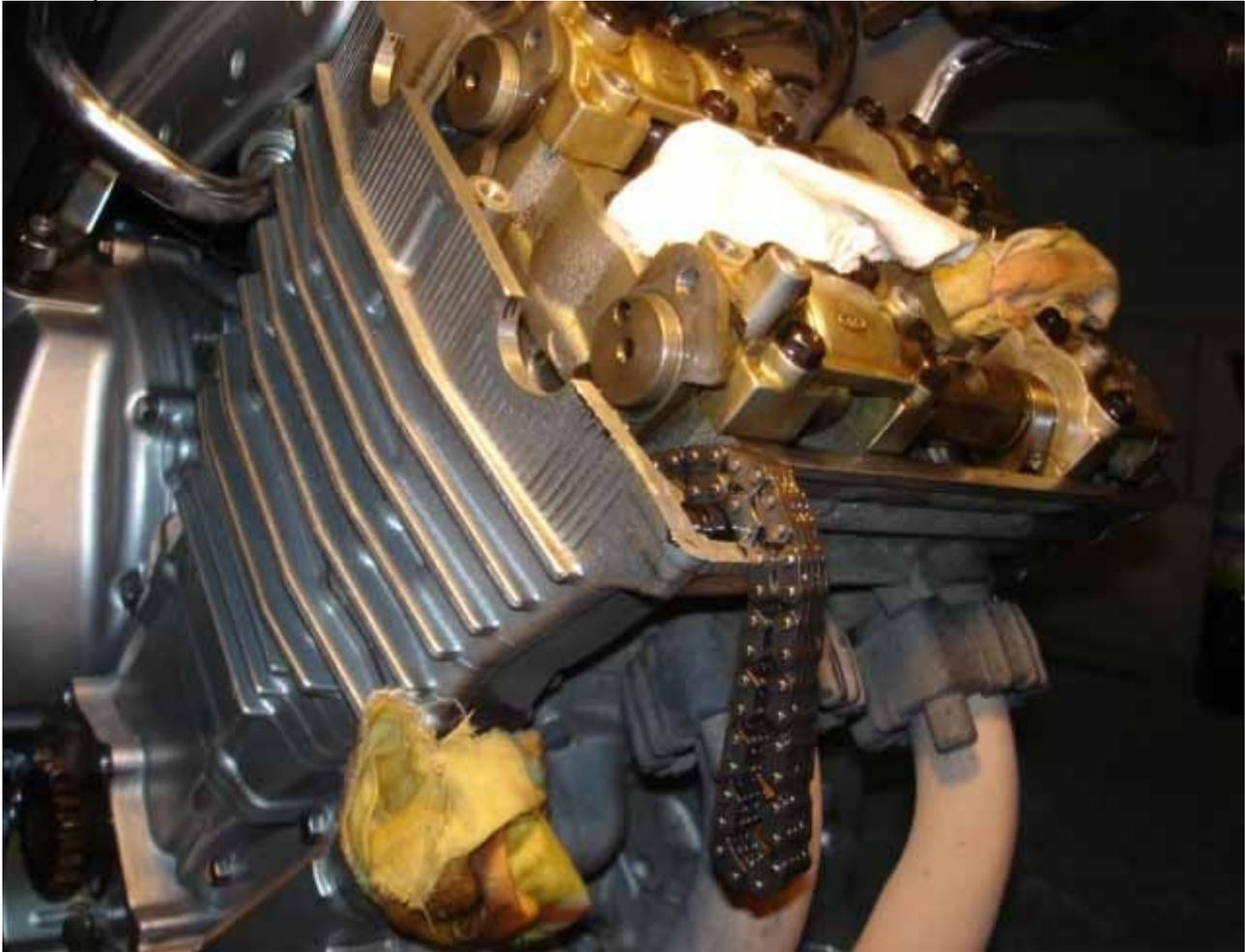
Photo des guides et tendeurs de chaîne :
