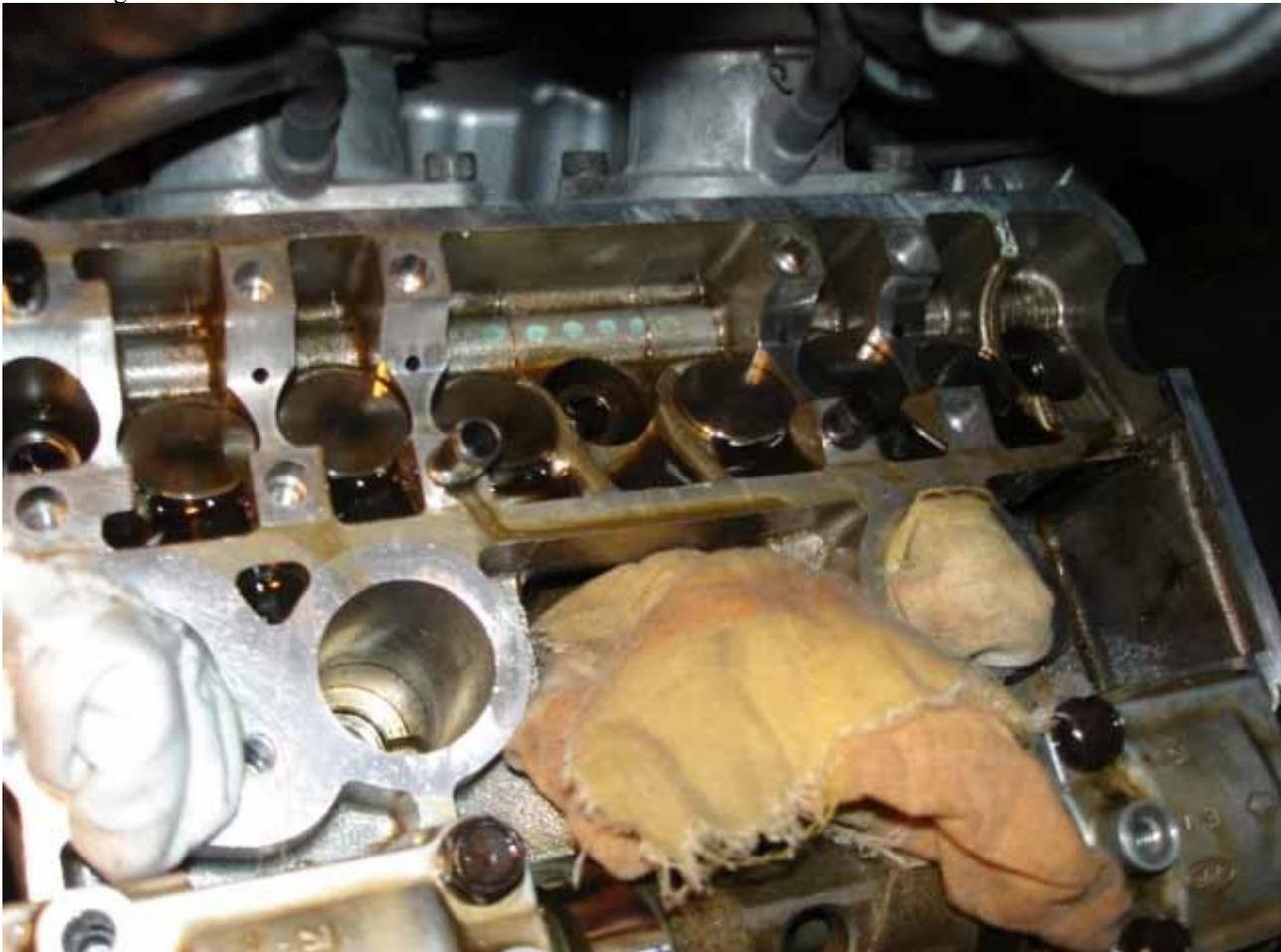
Photo des guides et tendeurs de chaîne :
