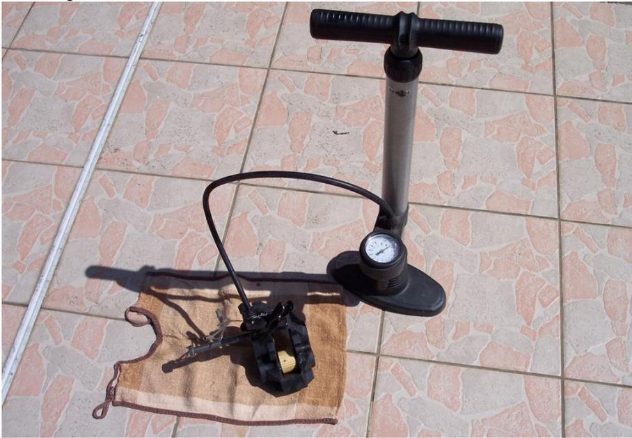
Il faut boucher l'arrivée à l'aide de la grosse vis (un tour de vis suffit), puis positionner la cale. Ensuite, il faut brancher la pompe à vélo sur la vis de purge (dévisser pour laisser passer l'air). Puis pomper jusqu'à ce qu'un des deux pistons non bloqués par la cale sorte de son logement.
