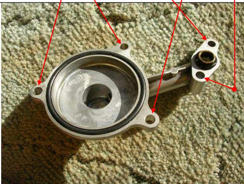
On enlève le couvercle, le filtre et on vérifie l'état des 2 joints toriques.
