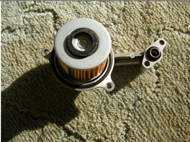
Une fois nettoyés, le couvercle, le filtre, les 2 joints toriques et la bague avec son petit joint, tout remonter
